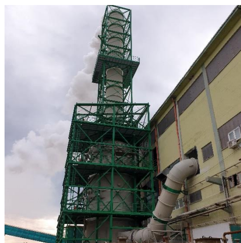
Слика 5. Мерна места на завршној кули – скрубери и емитер завршне куле - скрубери
